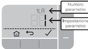
**A)** Parametre listesinde gezinmek için ✓ ve ↵ tuşlarına basın.
