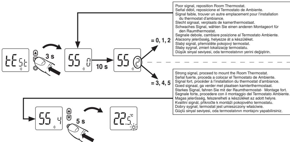
**3.5** **GB** Mounting the Room Thermostat **E** Colocación del Termostato de Ambiente
